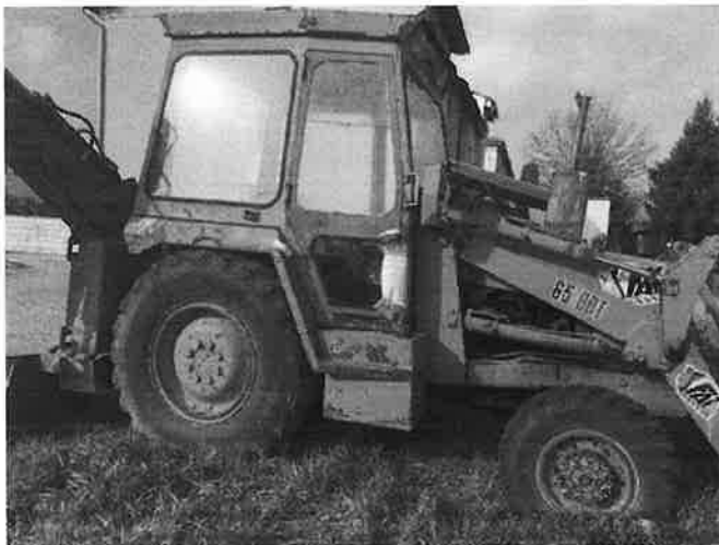
4. n. 1 Terna "FAIS dotata di pala anteriore (35b) e posteriore 65DB7, anno di fabbricazione 1979, in pessime condizioni di manutenzione, priva di apertura porta sinistra;
